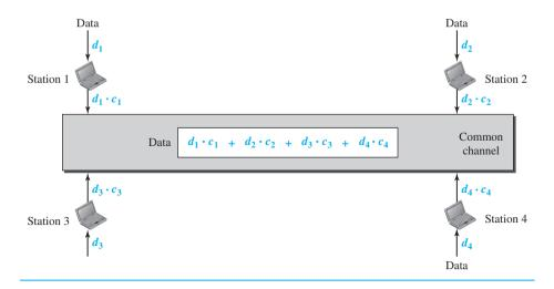
$$data = (d_1 \cdot c_1 + d_2 \cdot c_2 + d_3 \cdot c_3 + d_4 \cdot c_4) \cdot c_1$$
